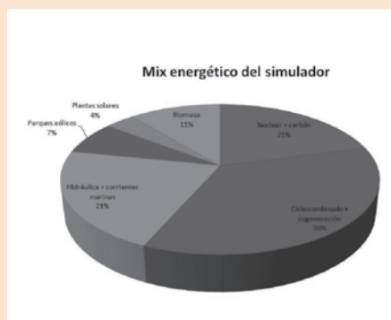
Figura 9. Estructura de la generación eléctrica del simulador
